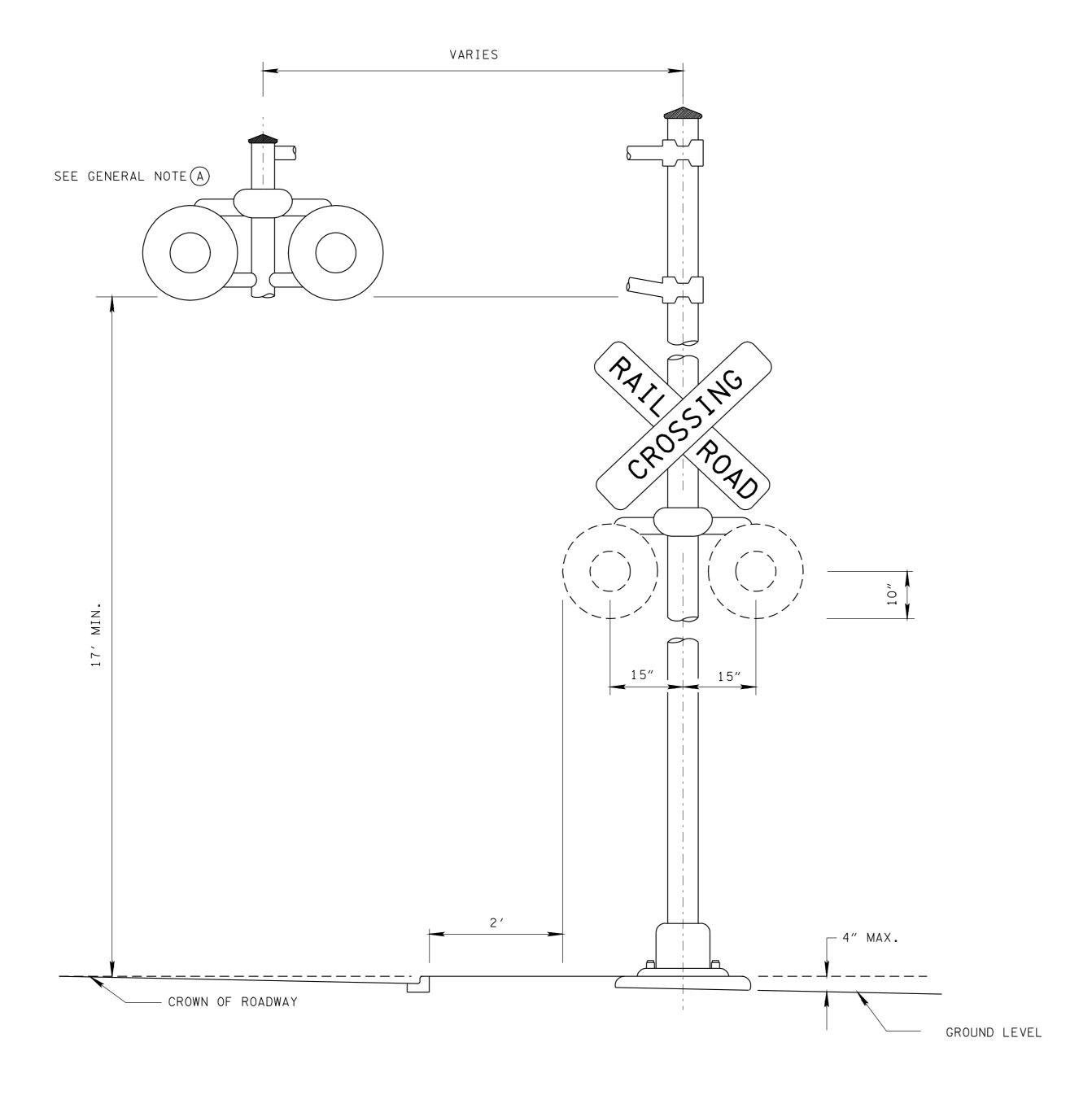
RAILROAD-HIGHWAY CROSSING CROWN TYPICAL CANTILEVER SPAN
